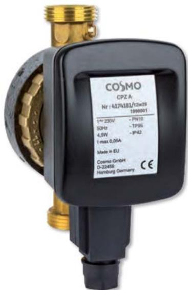
Энергоэффективный циркуляционный насос с мокрым ротором с резьбовым соединением для монтажа в системах питьевого водоснабжения, с устойчивым к токам блокировки синхронным двигателем. Корпус насоса из латуни, рабочее колесо и вал из нержавеющей стали.
