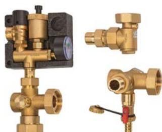
Для отопительного котла с подключениями 1½" НР, включая группу безопасности котла, манометр, предохранительный клапан ½" 3 бар, воздухоотводчик и теплоизоляцию, угловой обратный клапан, крестовина обратной линии с KFE-краном ½" и подключением 1" к бойлеру, подключение к отопительному контуру 1" ВР.
