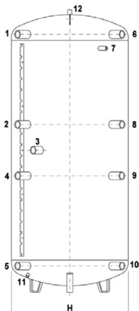
Буферный бак COSMO изготовлен из стали S235JR, снаружи огрунтован. У емкостей до 2000 л., включительно – регулируемые ножки.
