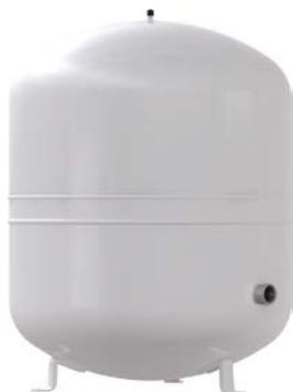
Мембранный расширительный бак для закрытых систем отопления и холодоснабжения. Работает по принципу статического поддержания давления с азотной подушкой. Газовая и водяная камеры отделены друг от друга мембраной.
