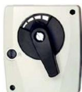
С кабелем длиной 2 м. Для непосредственного монтажа на смесителе насосных групп МК. Переключатель режимов – ручной/ автоматический и наглядная шкала степени открытия/закрытия. Подключение к сети: 230 В/ 50 Гц. Потребление мощности: 2,5 В·А. Крутящий момент 6Нм, цикл 140 сек.
