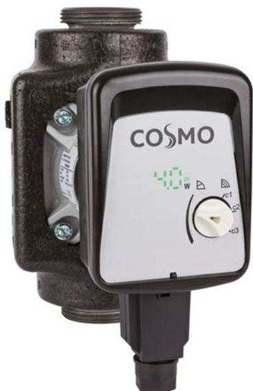
Высокоэффективный циркуляционный насос с мокрым ротором с резьбовым соединением для монтажа в системах отопления. Корпус насоса из серого чугуна, рабочее колесо из полипропилена, стальной вал с подшипниками скольжения из металлографита.
