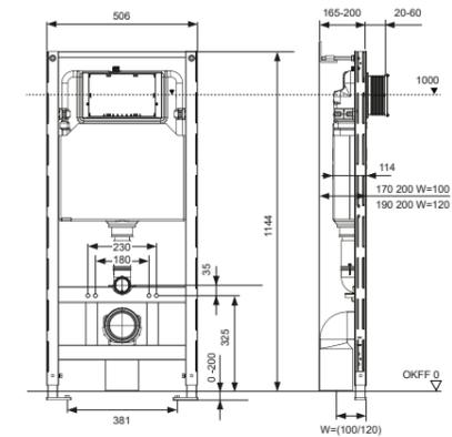
В основе всех модулей TECEspring — усиленная рама, выдерживающая нагрузку не менее 400 кг. Бачок во всех модулях оснащен системой двойного смыва с возможностью настройки. Модули TECEspring подходят для любых подвесных унитазов, но совместимы только с панелями смыва TECEspring.
