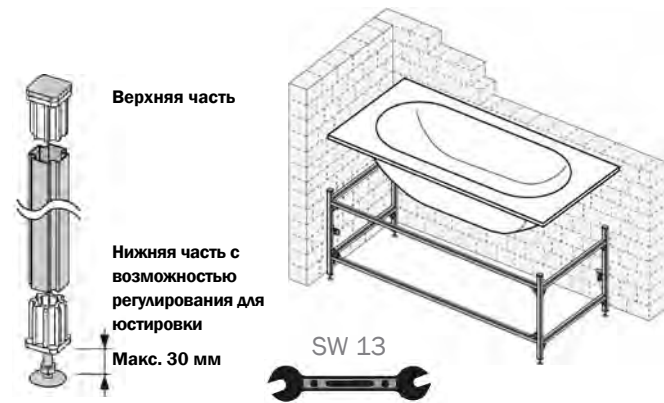
Установка стальной ванны в несущий каркас ТЕСЕprofil
