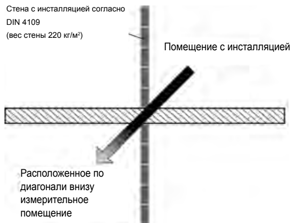
Положение измерительного пространства и пространства с инсталляциями
