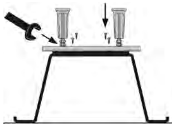
Монтаж опор для акриловой ванны
