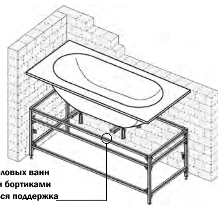
Монтаж опор для акриловой ванны
