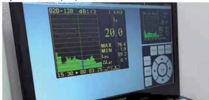
Для определения факторов, влияющих на уровень шума систем внутренней канализации из полимерных труб и разработки перспективной продукции с улучшенными параметрами по уровню шума на заводе компании «СИННИКОН» создана акустическая лаборатория.
