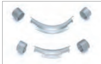
Рис. 8-3 Фиксаторы поворота (водоснабжение) (3-4 x Ø) – 90° или 45° для изгиба труб Ø 16-32
