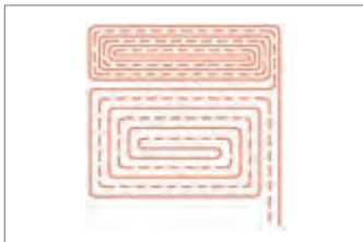
Рис. 15.4-1 Способ укладки улитка с присоединенной граничной зоной
