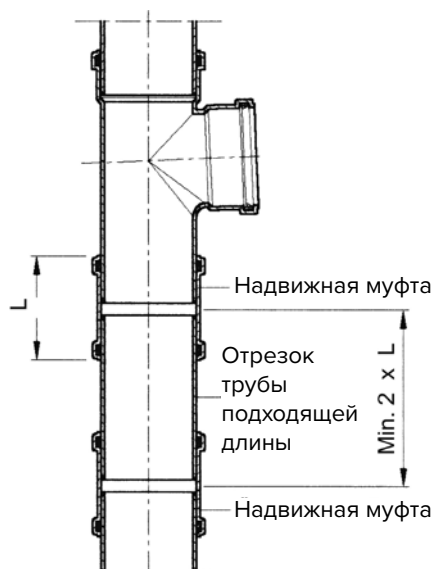
Монтаж тройника с двумя подвижными муфтами
