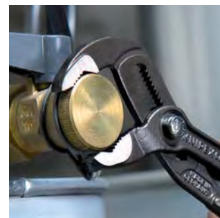
Плоскогубцы захватные (плоскогубцы, длинногубцы, клещи сантехнические и т.д.)
