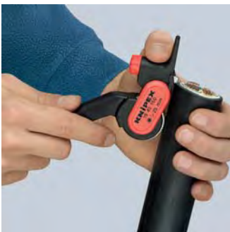
Установка инструмента для продольного реза
