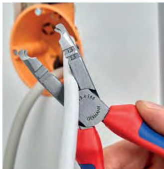
Резание кабеля диаметром до 13 мм
