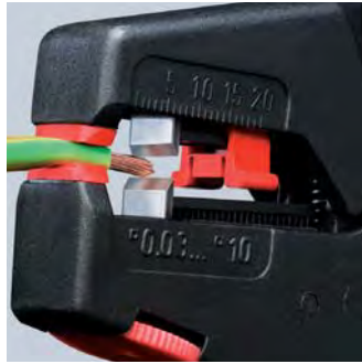
12 40 200: прецизионное удаление изоляции без повреждения проводника
