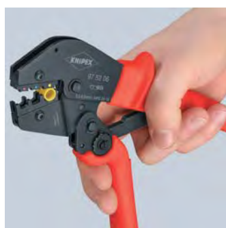
Первый этап: двумя пальцами подвести ручку так, чтобы обе губки легли на обжимаемый контакт
