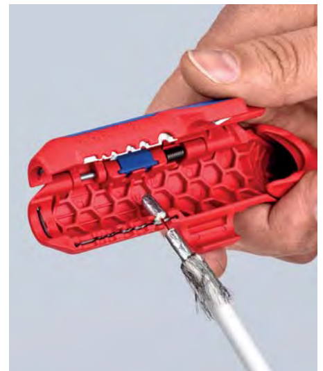
Удаление изоляции с дата-кабеля
