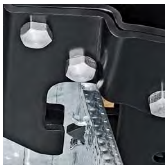
Пуансон инструмента продавливается через профили
