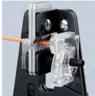
Ровное надрезание изоляции по всей окружности кабеля
