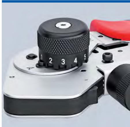
Стандартный механизм позиционирования
