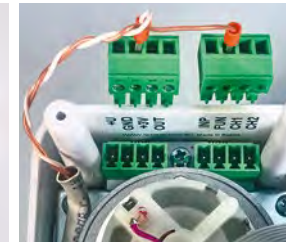
Фото 18. Подключение проводного выключателя к электроприводу
