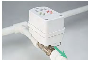
Фото 27. Удаление металлического фиксатора для отсоединения электропривода от шарового крана или ручного управления шаровым краном
