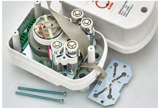
Фото 31. Контактная площадка снята, батарейки могут быть заменены
