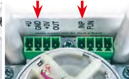
Фото 13. Клеммы подключения проводных датчиков — INP, GND
