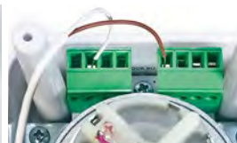
Фото 15. Подключение датчика к электроприводу
