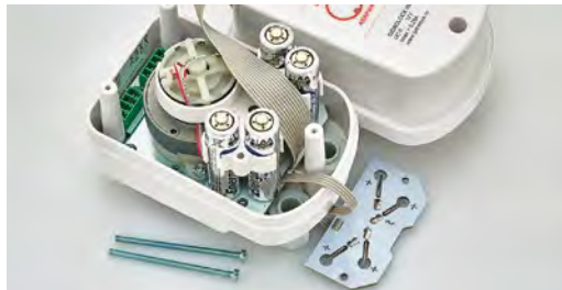
Фото 17. Контактная площадка снята, батарейки могут быть заменены
