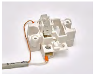
Фото 22. Подключение проводного выключателя
