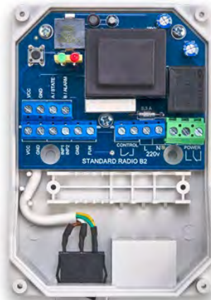
Фото 2. Блок управления GIDROLOCK STANDARD RADIO со снятой верхней крышкой.
