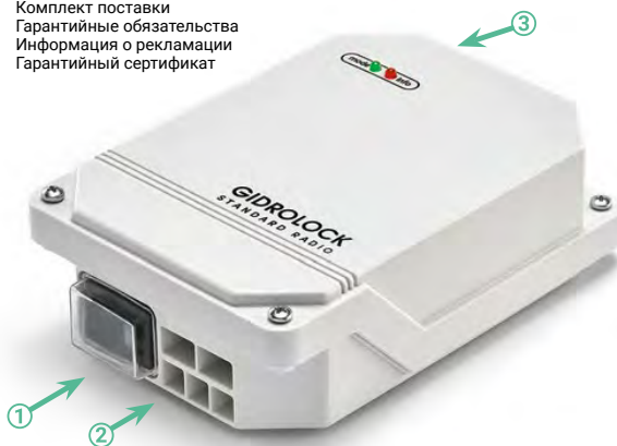
Фото 1. Блок управления GIDROLOCK STANDARD RADIO. (1) – переключатель «СЕТЬ» со встроенным индикатором включения питания; (2) – красный и зеленый светодиоды – индикаторы режима работы блока; (3) – отверстия для ввода кабелей питания, управления шаровыми приводами, датчиков протечки воды и прочих внешних устройств.
