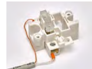
Фото 5. Подключение проводного выключателя
