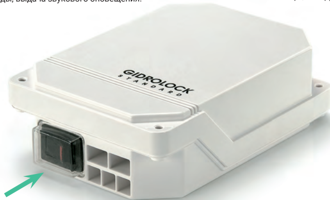
Фото 1. Блок управления GIDROLOCK STANDARD. Переключатель «Сеть» со встроенным индикатором включения питания, отверстия для ввода кабелей питания, управления шаровыми электрическими приводами, датчиков протечки воды и блока радиоприемника системы GIDROLOCK RADIO
