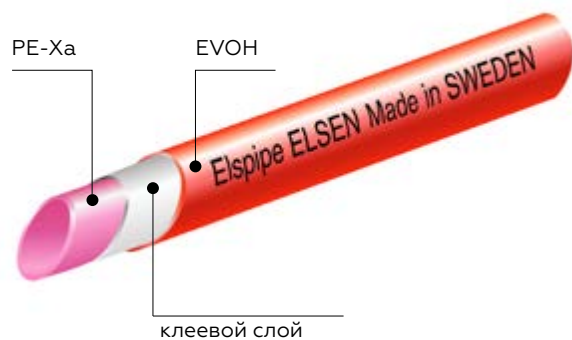
Рис.1 Конструкция труб серии EPU и EPF
