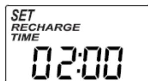
Если нужно изменить время начала регенерации, то нужно нажимать кнопки  $\wedge$  или  $\vee$  для установки иного времени. При программировании времени начала регенерации при 12-ти часовом режиме часов следует обратить внимание на обозначение *AM* (между 00<sup>00</sup> и 11<sup>59</sup>) или *PM* (между 12<sup>00</sup> и 23<sup>59</sup>). Нажатие кнопки **Выбор/Меню** фиксирует введенные изменения времени начала регенерации.
