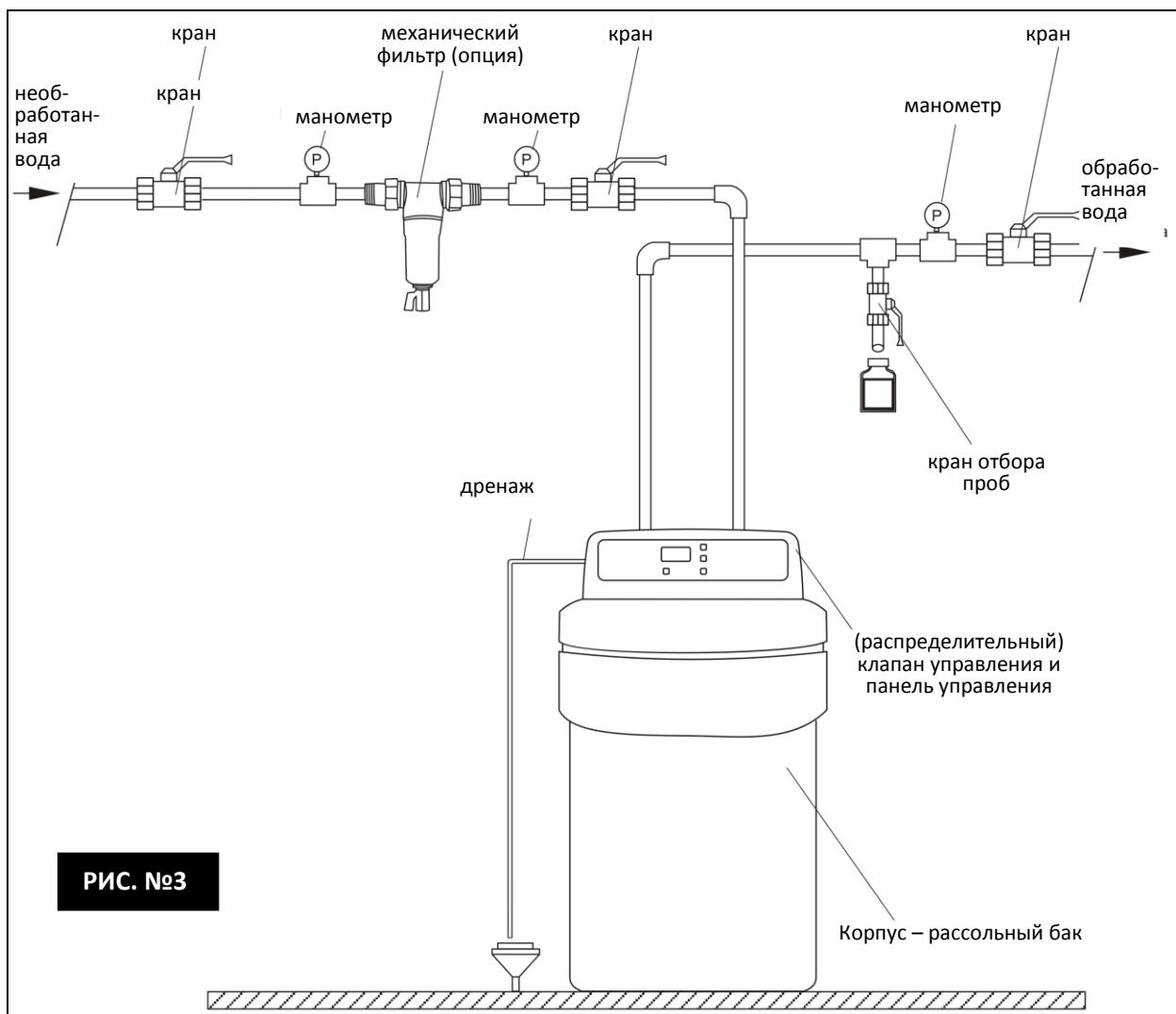
Гидравлическое подключение устройства следует выполнять в соответствии со схемой на РИС. №3. Устройство может поставляться с моноблочным обходным краном (байпасом) с элементами подключения и шлангом для дренажа. Комплектация системы такими элементами как: краны, манометры, фильтр механической очистки и т. д., должна быть выполнена лицом производящим монтаж, так как эти элементы не входят в комплектацию устройства.
