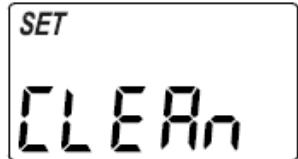
**ДОПОЛНИТЕЛЬНАЯ ПРОМЫВКА (CLEAN):** Эту функцию рекомендовано активировать ON. Тогда происходит дополнительная очистка обратным и прямым потоком слоя загрузки, перед ее регенерацией солевым рассолом. Если на экране есть надпись OFF (выкл), то с помощью кнопки  $\wedge$  или  $\vee$ , нужно переключаться с OFF (выкл) на ON (вкл).
