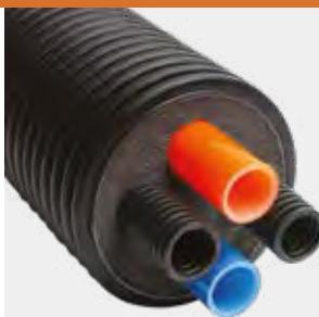
Трубы для передачи рабочей среды изготовлены из свитого полиэтилена PE-Xa с оранжевым барьером для препятствия диффузии кислорода для подающей линии отопления и синим - для обратной линии отопления. Гофрированные трубы изготавливаются из полипропилена.
