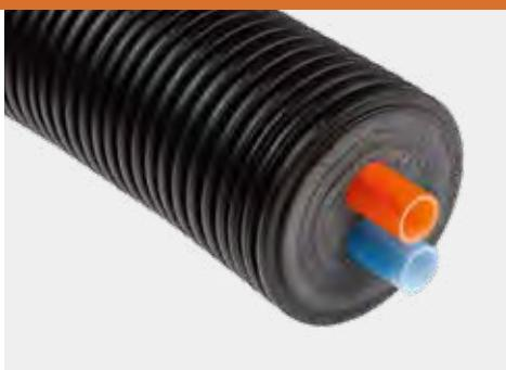
Многослойная теплоизоляция изготовлена из свитого микропористого пенополиэтилена PE-X с водоотталкивающей закрытой ячеистой структурой, характеризующейся прочными, стойкими к износу изоляционными характеристиками и постоянной эластичностью, обеспечивающей максимальную и неизменную толщину изоляционного слоя, даже после многократного сгиба.
