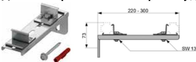
Двойное крепление для монтажа одновременно двух профилей TECEprofil к конструкции. Для несущих конструкций с глубиной 220–300 мм. Блок из оцинкованной стали в сборе в комплекте с крепёжными элементами.
