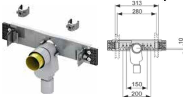
Монтажная пластина из оцинкованной стали со звукоизоляцией для установки уголков с настенным креплением со встроенным сифоном DN 50 в сборе, NW30, съёмная U-образная вставка (также служит для уплотнения), в комплекте с защитными заглушками, крепёжными элементами для крепления профилей TECEprofil, установочными элементами 2 x M10 и крепежом для раковины.
