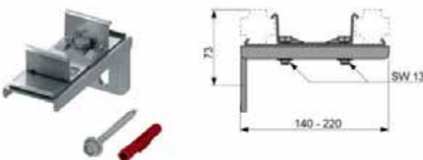
Двойное крепление для монтажа одновременно двух профилей TECEprofil к конструкции. Для несущих конструкций с глубиной 140–220 мм. Блок из оцинкованной стали в сборе в комплекте с крепёжными элементами.
