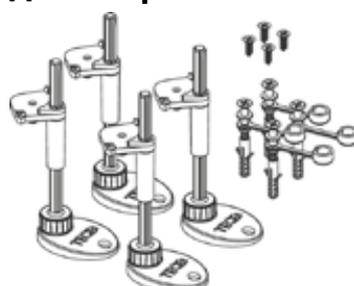
Комплект опор для сифонов TECEdrainpoint S с универсальным фланцем Seal System для регулирования высоты и крепления на этапе монтажа до окончательной отделки.
