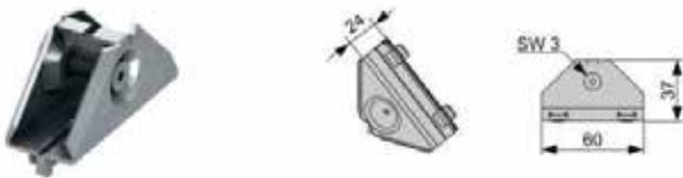
Угловое соединение для жёсткого прямоугольного соединения профилей TECEprofil. Блок в сборе из оцинкованной стали. Винт под торцевой ключ М5 (SW 3) и нажимная пружина.
