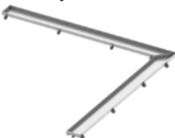
Основа для плитки для душевого канала TECEdrainline (углового), из нержавеющей стали (глянец), для установки в корпус канала, с видимыми кромками. Плитка может крепиться на эластичный клей, например, на основе силикона или эпоксидной смолы. Нагрузка 300 кг.
