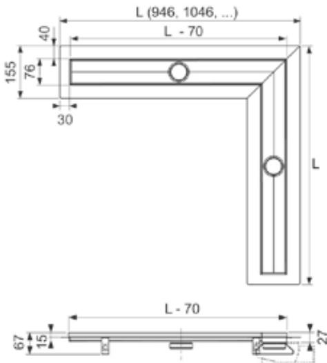
Угловой душевой канал 90° TECEdrainline из нержавеющей стали для монтажа в бетонную стяжку, с изолирующим фланцем и кронштейнами для крепления опор (приобретаются отдельно). Установочная высота до уровня чистого пола в зависимости от модели сифона: 67/68,5/95/120/148 мм.
