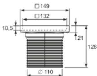
Комплект состоит из основы для укладки плитки 142 x 142 мм и рамки основы с удлинительным элементом.
