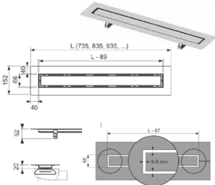
Прямой душевой канал TECEdrainline из нержавеющей стали для монтажа в бетонную стяжку с облицовкой крупной кафельной плиткой или плитами натурального камня, с изолирующим фланцем и кронштейнами для крепления опор (приобретаются отдельно). Установочная высота до уровня чистого пола в зависимости от модели сифона: 52/61,5/87/112/140 мм.
