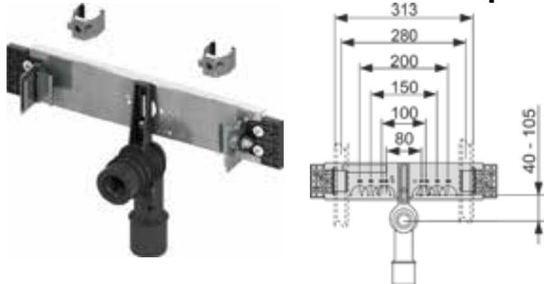
Монтажная пластина из оцинкованной стали со звукоизоляцией для установки уголков с настенным креплением с узлом в сборе: соединительное колено DN 40/50, резиновая муфта, защитная заглушка, крепёжные элементы для крепления профилей TECEprofil, установочные элементы 2 x M10 и крепёжные элементы для раковины.
