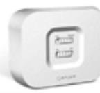
RX10RF  | Модульное реле, беспроводное, для управления котлом или одной зоной отопления (насосом, клапаном, сервоприводом и т. д.), с питанием 220В, с беспотенциальным выходным контактом COM/NO                                              | 176,09     |
