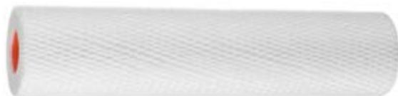
Изготовлен из вспененного полипропилена. Имеет градиентную пористость: диаметр поры уменьшается при движении воды внутрь картриджа, благодаря чему работает весь объем фильтрующего материала.
