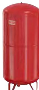
\* Для баков Flexcon R максимальная допустимая температура теплоносителя до +120 °C, при длительной эксплуатации на мембране до +70 °C.
