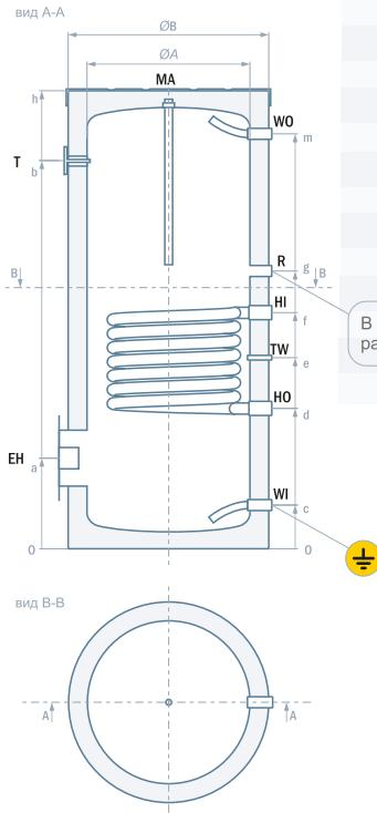
В модели BS-150/30Z выход рециркуляции располагается ниже входа теплоносителя
